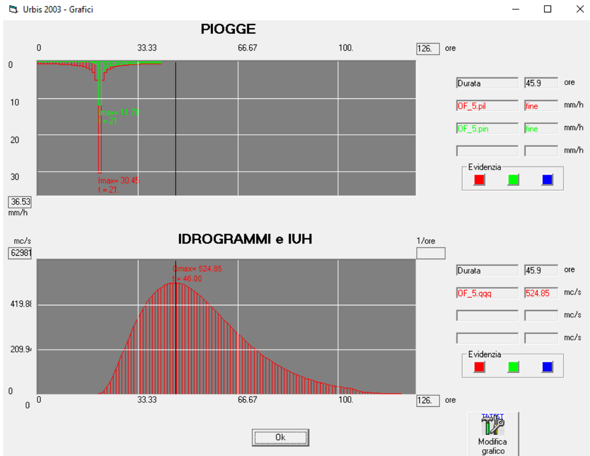
Fig. 7: Piogge lorde, nette ed idrogramma corrispondenti ad evento con tempo di ritorno pari a 5 anni
